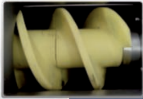
Kunststoff Snäcke: sauberes Trommelsieb
