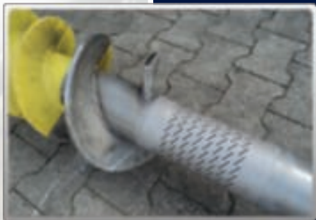
Ebenso Feuchtigkeitsabfuhr über die Hohlwelle
